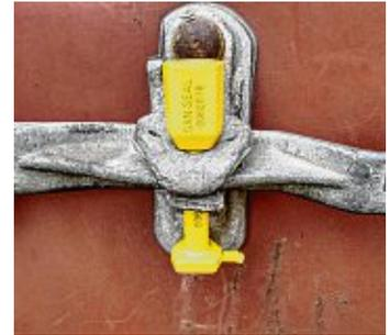
Solche Plomben zeigen an, ob der Container unbefugt geöffnet wurde.
